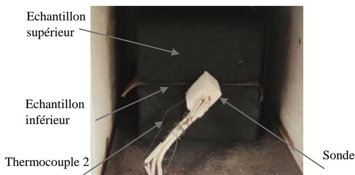
Figure 4.20 : Echantillons assemblés avec la sonde et le thermocouple
