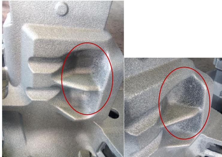
**Niveau 3 :** Le défaut est situé sur une ou deux faces extérieures de la trompette et dans les zones creuses avec une épaisseur plus grande que le niveau 2.
