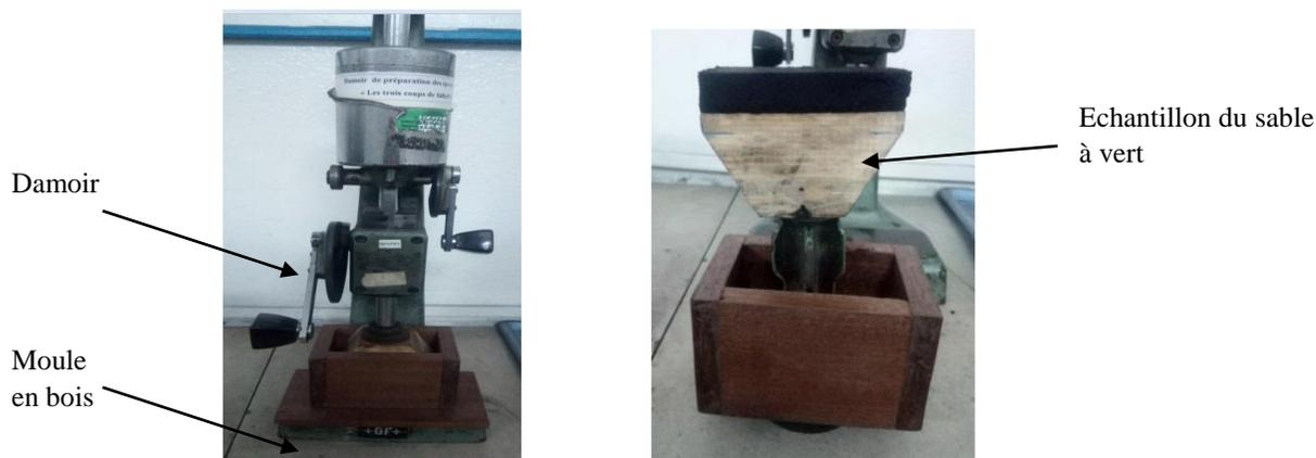
Figure 4.13: Fabrication des éprouvettes de caractérisation par THB.
