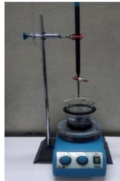
Figure 2.7 : Agitateur magnétique et burette graduée
