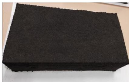
Figure 4.17: Echantillons de sable à vert
