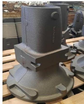
Figure 1.9: Exemple des pièces après l'opération de grenailage
