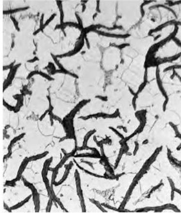
Figure 1.16: Micrographies optiques de la fonte grise : les lamelles de graphite foncé sont noyées dans une matrice ferritique. 500×. [25].
