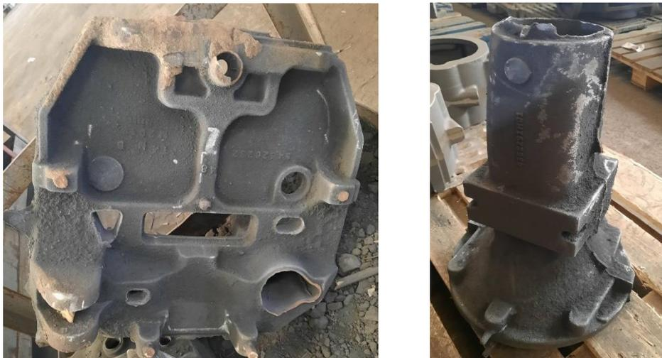
Figure 1.7: Exemple des pièces après décochage et avant parachèvement
