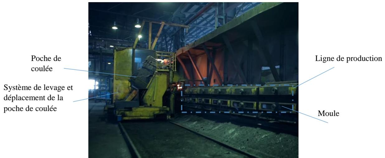
Figure 1.6: Remplissage du moule
